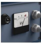
Die Stückprüfung bei 10.000 Volt gemäß IEC 60900 garantiert sicheres Arbeiten unter Spannung bis 1.000 Volt.
