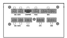
1x 20+4-pin mainboard (2x M/B) 1x 4+4-pin CPU (CPU) 2x 6+2-pin PCIe (PCI-E) 4x SATA (IDE/SATA) 1x 12VHPWR
