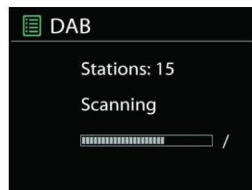
Na spustenie skenovania stlačte tlačidlo "MENU" na diaľkovom ovládači alebo stlačte a podržte tlačidlo "MENU / INFO", aby ste vstúpili do ponuky DAB. Vyberte možnosť „Úplné skenovanie“ a potvrdte tlačidlom „OK“ alebo stlačte tlačidlo „SKENOVATĚ“ na diaľkovom ovládači.
