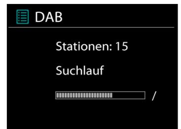
Um die Suche zu starten, drücken Sie die „**MENÜ**“ Taste auf der Fernbedienung oder drücken und halten Sie die „**MENÜ/INFO**“ Taste um in das DAB-Menü zu gelangen. Wählen Sie die Option „Vollständiger Suchlauf“ und bestätigen Sie mit „**OK**“ oder drücken Sie die „**SCAN**“ Taste auf der Fernbedienung.
