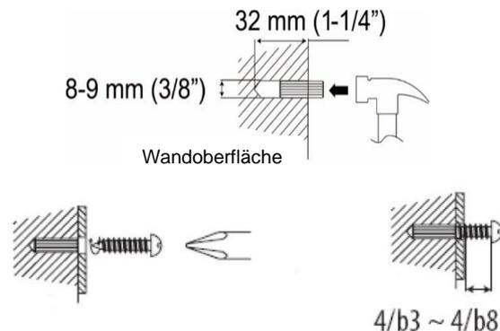
Nehmen Sie den Stand Fuß des Gerätes ab, indem Sie die Beiden Verriegelungen an der Unterseite des Standfußes vom Gerät wegziehen. Schieben Sie den Stand Fuß nach hinten und ziehen ihn ab. Nun können sie Ihr Gerät wie im Bild gezeigt aufhängen
