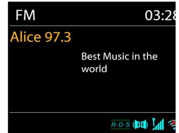
Om handmatig te scannen, houdt u de "◀◀" of "▶▶" knop ingedrukt. De frequentieweergave begint te lopen en scant de FM-band en stopt bij het volgende station.
