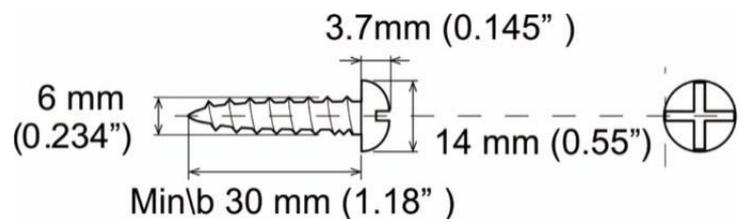
Utilisez un morceau de papier comme gabarit de perçage et marquez les trous à environ 160 mm d'intervalle. Fixez ensuite le gabarit de perçage au mur en position horizontale. (Comme illustré) et percez les deux trous.
