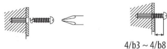
Verwijder de basis van het apparaat door de twee vergrendelingen aan de onderkant van de basis weg te trekken van het apparaat. Duw de standaardvoet naar achteren en trek hem eraf. Nu kunt u uw apparaat ophangen zoals op de afbeelding wordt getoond
