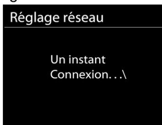
L'appareil tente de se connecter au réseau choisi. Si la connexion est réussie, l'ICD1010 s'affichera comme étant connecté. Si la connexion échoue, l'appareil retourne à la page précédente. Appuyez sur « **OK** » pour quitter l'assistant de configuration.
