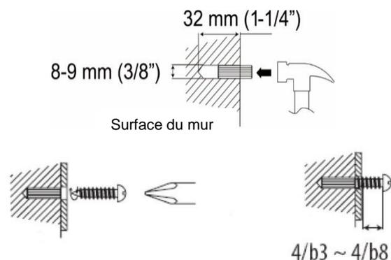
Retirez la base de l'appareil en tirant les deux verrous sur la face inférieure de la base loin de l'appareil. Repoussez le pied du support et retirez-le. Vous pouvez maintenant raccrocher votre appareil comme indiqué sur l'image
