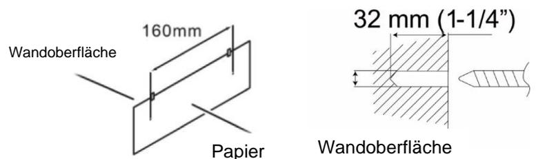
Befestigen Sie, unter Verwendung von geeigneten Dübeln, die Schrauben wie in den Bildern gezeigt
