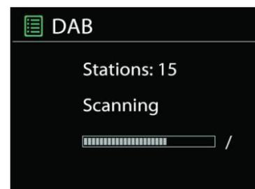
Pro spuštění skenování stiskněte tlačítko „**MENU**“ na dálkovém ovládacím nebo stiskněte a podržte tlačítko „**MENU / INFO**“ pro přístup do nabídky DAB. Vyberte možnost „Úplné skenování“ a potvrďte pomocí „**OK**“ nebo stiskněte tlačítko „**SKENOVAT**“ na dálkovém ovládacím.
