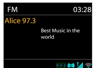
Für eine manuelle Abstimmung drücken und halten Sie die Taste „◀◀ / ▶▶“, bis der Suchlauf startet. Der Suchlauf stoppt beim nächsten gefundenen Sender.
