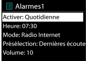
Sélectionnez « Alarm » dans le menu principal pour régler ou modifier une alarme. Sélectionner le numéro de l'alarme (1 ou 2) puis configurez les paramètres suivants:
