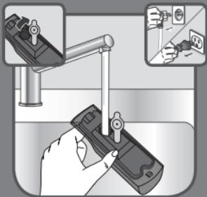
Spremnik za vodu napunite sa 100% vode i ponavljajte postupak dok se spremnik za vodu potpuno ne isprazni radi ispiranja aparata.
