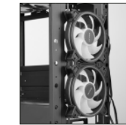
Lüfter an die Front halten, Luftstrom beachten Hold fans on the front, follow airflow
