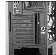
Lösen Sie die Thumbscrew und schieben Sie die Halterung zur Seite. Loose the Thumbscrew and move the bracket aside.
