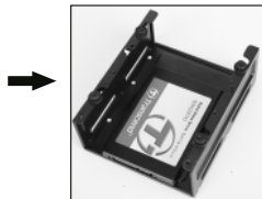
Platzieren Sie die SSD und befestigen Sie sie mit 4 Schrauben. Place the SSD and fix it with 4 screws.
