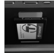
SSD unter das Blech halten Hold the SSD under the metal panel
