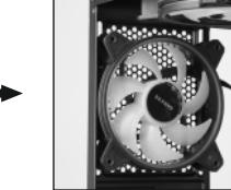
Lüfter hinter die Rückseite halten, Luftstrom beachten Hold fans behind the back side, follow airflow
