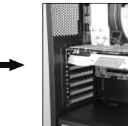
Schieben Sie die Grafikkarte vorsichtig in den Slot des Mainboards. Push the graphic adapter carefully into the slot of the Mainboard.
